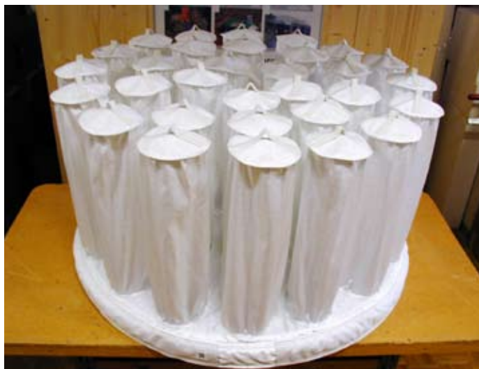
Im Hause konfektionierter Wirbelschichttrockner mit antistatischem Gewebe.
