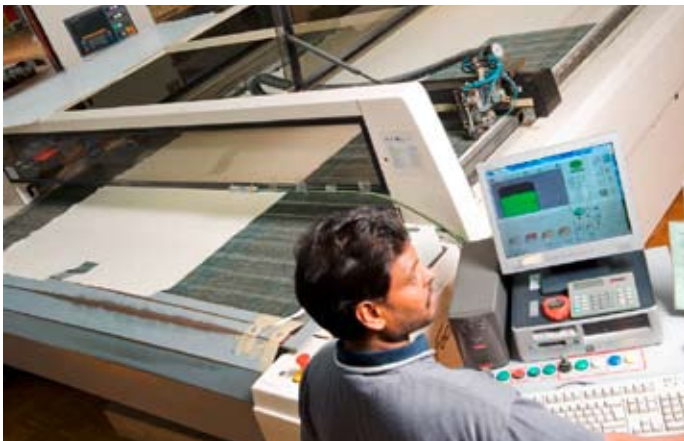
Hightech-Lasercutter CAD-gesteuert. Schnittbreite bis 248 cm.
