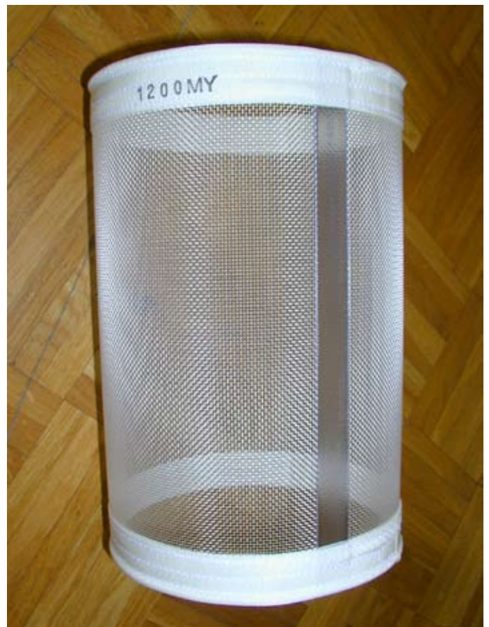
Siebzylinder mit geschweisster Naht.
